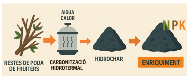
Figura 3. Fluxograma del procés d'obtenció i enriquiment de l'hydrochar.
